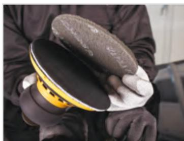
Для шлифования с пылеудалением используйте диски Mirlon и Mirlon Total вместе с мягкой сетчатой прокладкой Mirka
