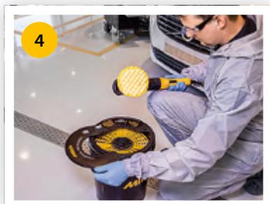
» Устройство для очистки полировальных дисков подходит для очистки всех типов дисков.
