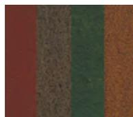
**Mirlon** - гибкий шлифовальный материал с зернами оксида алюминия, закрепленными на трехмерном нетканом полотне из полиамидного волокна. Удобен для обработки как плоских, так и сложных изогнутых и профильных поверхностей. Идеально подходит для операций матирования и подготовки поверхности для нанесения следующего слоя ЛКМ. Применяется как в сухом, так во влажном режиме ручного или машинного шлифования.
