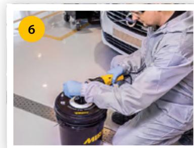
» Снимите полировальную машинку с решетки и просушите полировальный диск на скорости 1,500 – 2,000 об/мин.
